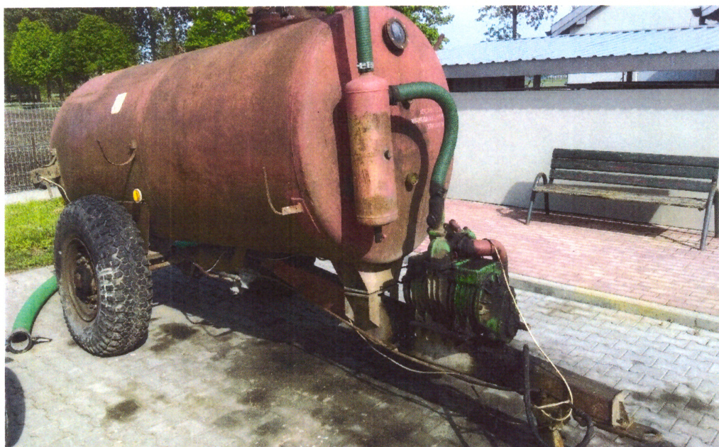
Przyczepa asenizacyjna jednoosiowa, pojemność 4000 l
